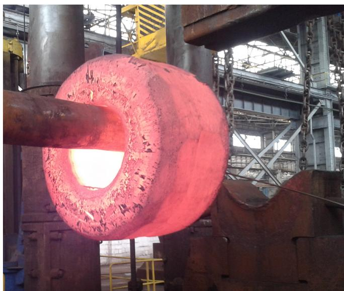
Рисунок 5.14 – Предварительная раскатка для увеличения внутреннего диаметра
