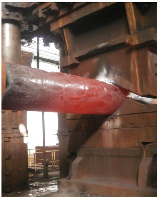
Рисунок 5.15 – Протяжка вырезными бойками
