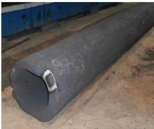
Рисунок 5.16 – Полученная поковка
