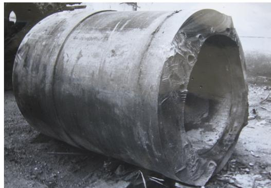
Рисунок 1.2 – Обрыв дна в сваркованном гидроцилиндре [14]
