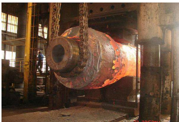
Рисунок 1.21 – Процессковки с использованием кантователя [74]
