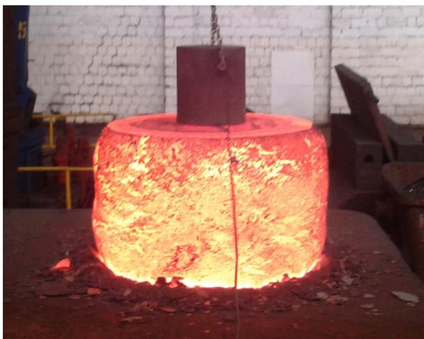
Рисунок 5.13 – Прошивка осаженной заготовки
